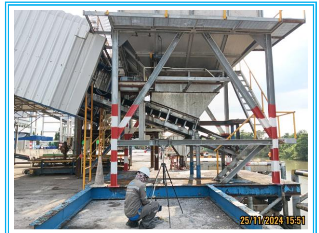
รูปที่ 4.2-76 แสดงการตรวจวัดค่าความทึบของฝุ่นละออง (Opacity) ท่าเทียบเรือที่ 2 ห่างจาก Hopper 1 เมตร วันที่ 25 พฤศจิกายน 2567
