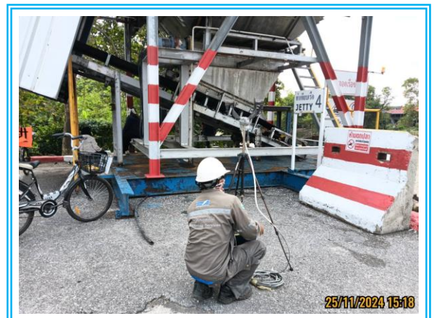
รูปที่ 4.2-78 แสดงการตรวจวัดค่าความทึบของฝุ่นละออง (Opacity) ท่าเทียบเรือที่ 4 ห่างจาก Hopper 1 เมตร วันที่ 25 พฤศจิกายน 2567
