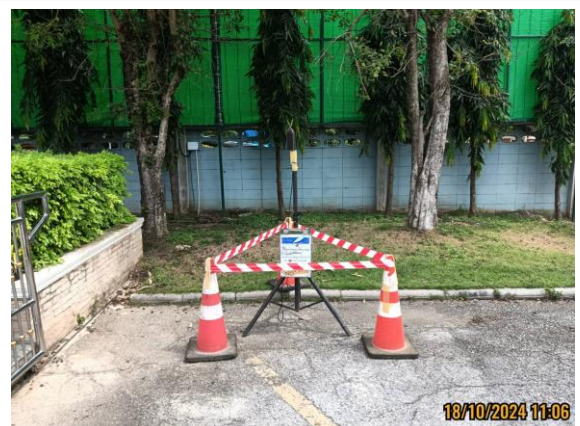
รูปที่ 4.2-82 แสดงการตรวจวัดระดับเสียงที่เกิดจากการประกอบ กิจการโรงงาน และระดับเสียงรบกวน บริเวณบ้านเลขที่ 40/1 บ้านแม่ลา หมู่ที่ 3 (ชุมชนด้านทิศตะวันออก) วันที่ 17-22 ตุลาคม 2567
