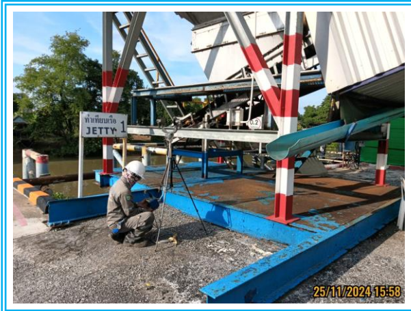
รูปที่ 4.2-75 แสดงการตรวจวัดค่าความทึบของฝุ่นละออง (Opacity) ท่าเทียบเรือที่ 1 ห่างจาก Hopper 1 เมตร วันที่ 25 พฤศจิกายน 2567
