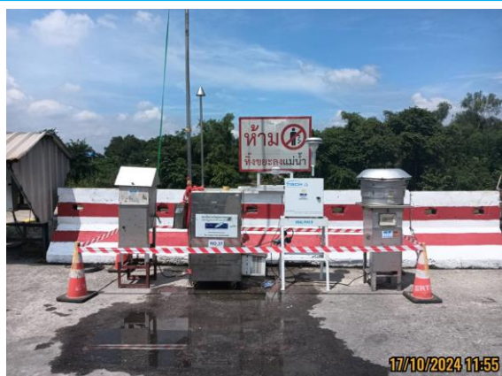
รูปที่ 4.2-67 แสดงการตรวจวัดคุณภาพอากาศในบรรยากาศ บริเวณพื้นที่หน้าท่า วันที่ 17-22 ตุลาคม 2567
